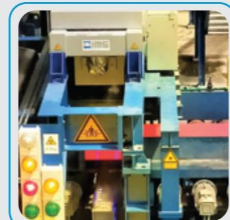
Thiết bị kiểm soát chất lượng IMS tự động, sử dụng bộ phát Xray để đo các tham số chiều dài, chiều rộng, độ phẳng... để điều chỉnh sản phẩm.
