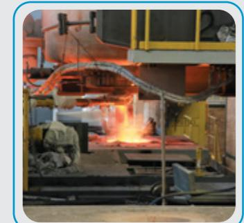
Dây truyền đúc tấm liên tục. Tự động điều chỉnh kích thước phôi. Tự động kiểm soát thông số công nghệ
