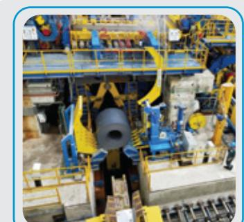
Khu hoàn thiện quy cách sản phẩm và lấy mẫu kiểm tra tính chất cơ học. Sản phẩm được quản lý bằng mã vạch QR code
