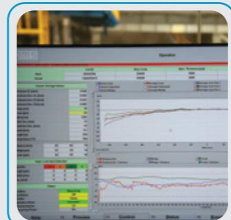
Mỗi cuộn được lập báo cáo kiểm soát chất lượng và liên kết với phần mềm quản lý sản xuất Danieli/SAP
